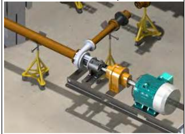
Tubería de succión típica
