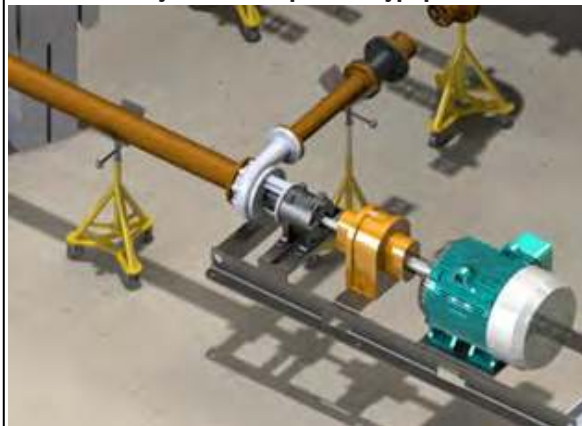
Tuyauterie d'aspiration typique
